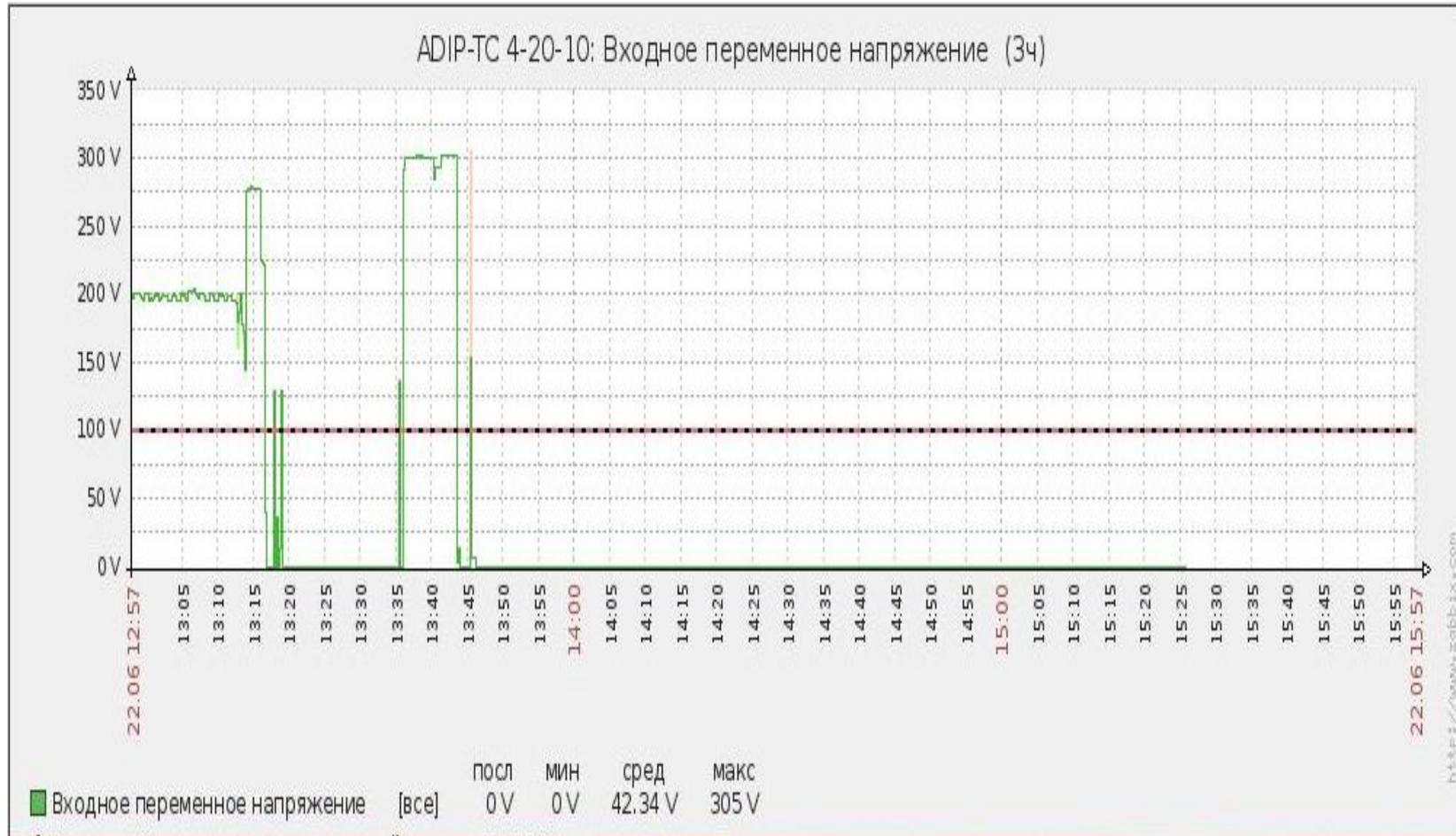
*Реальное отображения колебания напряжения на объекте*
